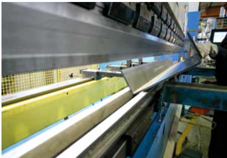
Plegadora Metal sheet bending
