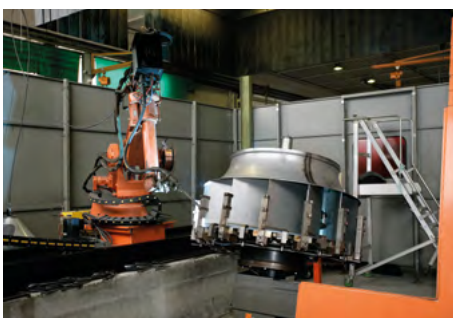
Soldadura robotizada Robotised welding
